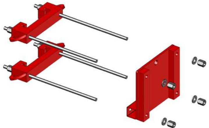
Die Gurtungsklammer hintergreift die äußere Trägerführung, umklammert den Gurtungsträger (z.B. HEM 500) und stellt eine kraftschlüssige Verbindung her. Die auftretenden Kräfte werden über diese Verbindung an die äußeren Gleitschienenträger abgeleitet.
